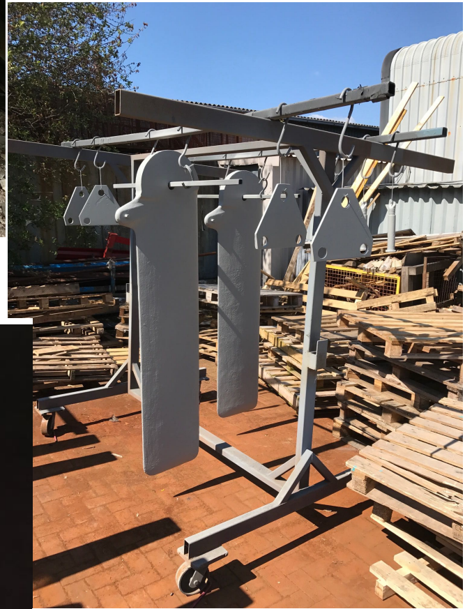
Zinc sprayed keels
